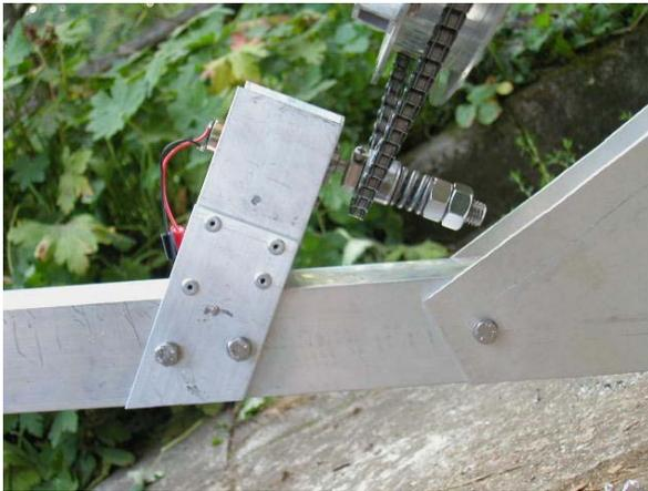
Fixer l'axe d'entraînement avec sa vis M4 à l'axe du réducteur (auparavant: arrondir le bout de la vis M4 en limant). Si l'extrémité reste pointue, la vis se desserre après un temps). La vis M4 doit être serrée sur la partie plate de l'axe du réducteur. Maintenant attacher l'ensemble au support comme vous le voyez sur la photo de dessus. Utiliser des vis M6 x 70.
