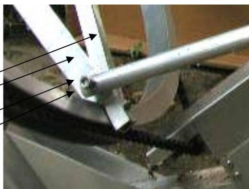
Les deux extrémités de chaque tube télescopiques doivent être fixées du même côté du grand axe du réflecteur (ainsi ils ne sont pas fixes diagonalement). Pour toutes les vis, maintenir un écart, qui permet aux bras télescopiques de bouger lors des réglages : fixer la vis avec un écrou, réaliser l'écart suffisant et bloquer la vis avec un contre écrou.
