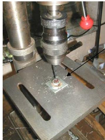
Fixer la vis à la table de perçage avec un écrou et des rondelles qui permettent de percer perpendiculairement
